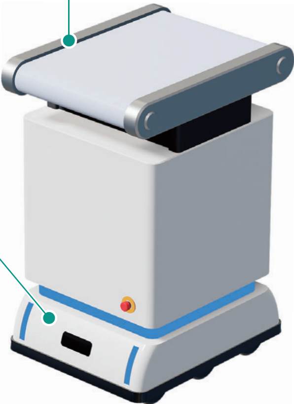
用途例：带传送带的自动搬运机器人
